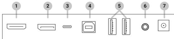
1. разъём HDMI для подключения цифрового сигнала от компьютера;
